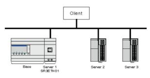
FIGURE 11. NETWORK ARCHITECTURE OF THE ETHERNET COMMUNICATION MODULE SR3NET01
